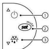
Přidržte tlačítko jednu sekundu, dokud nezačne nastavená teplota blikat.
